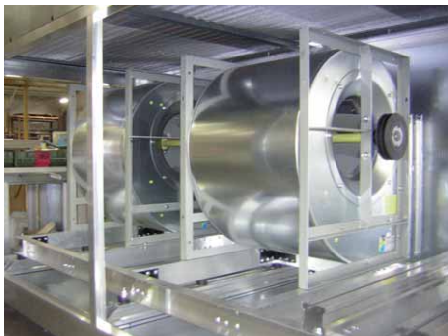
Costruzione UTA con ventilatore binato
